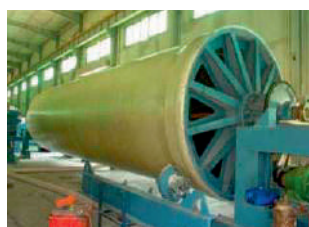
Изготовление внутреннего слоя
